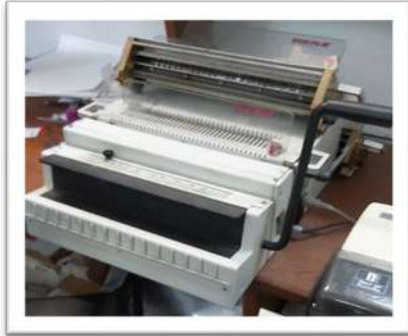
Perforelieur RENZ Reliure métallique 3:1 et 2:1 Reliure plastique
